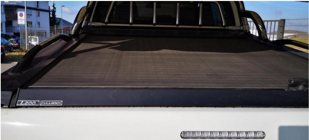
Rollverdeck SOT XXXX Roll in verbautem Zustand / roll cover SOT XXXX Roll mounted
